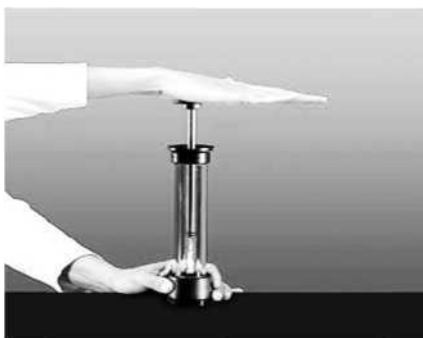
Εικόνα 1: Αναπαράσταση της επίδειξης της κατά προσέγγισης αδιαβατικής συμπίεσης
